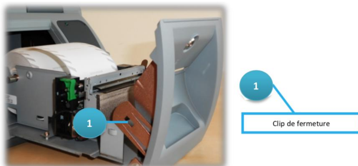
Figure 57. ouverture du couvercle avant de l'imprimante de l'ordinateur de vote
