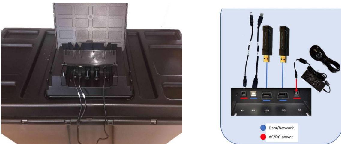
Figure 10. urne électorale avec clés USB dans le couvercle électronique
