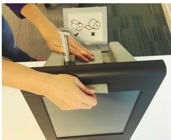
Figure 62. papier avec le côté gris vers le haut à travers la fente
